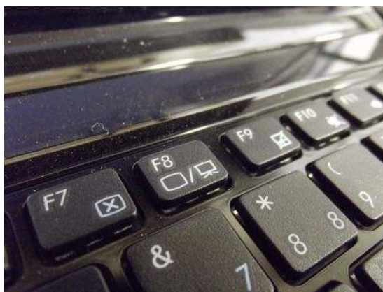
Figura 16 – Variação do desenho indicando a tecla de atalho para ativar a saída VGA (tecla F8)
