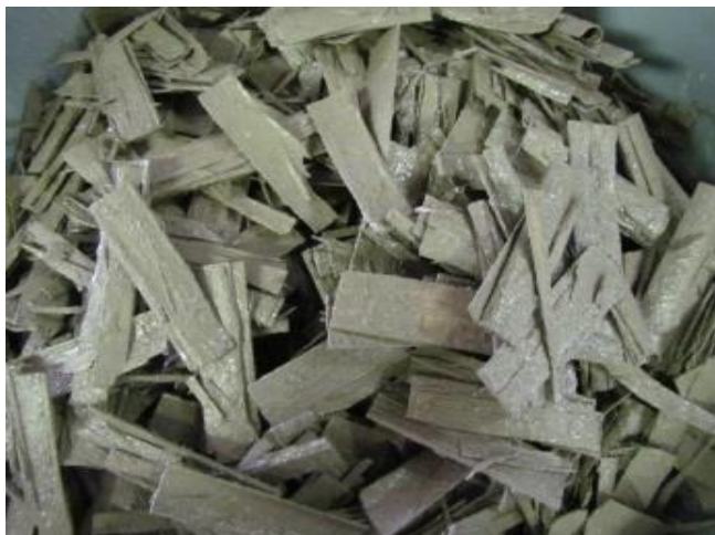
Madeira residual utilizada na conformação de painel cimento-madeira.
